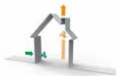
Systeem D mechanische toevoer, mechanische afvoer
