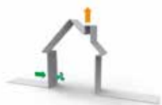
Systeem B mechanische toevoer, natuurlijke afvoer
